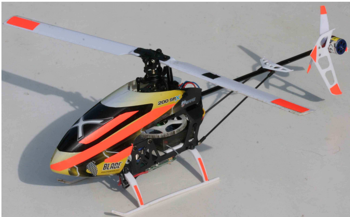
Abbildung 1 Blade 200 SRX selbst beklebt mit rot-links & gelb-rechts, um leichter bei Perspektivwechsel zwischen links und rechts unterscheiden zu können. Rotor-Oberseite mit Rot auf den Blattenden dekoriert. Bei Kurvenflug und Niedrigflug lassen sich die Fluglagen leichter erkennen.
